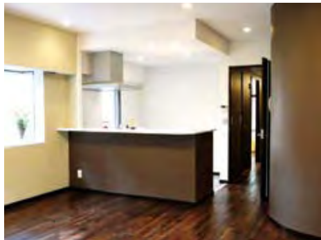
無垢材のフローリングと消臭・調湿効果のあるシラス壁でスタイリッシュ空間にリノベーション
